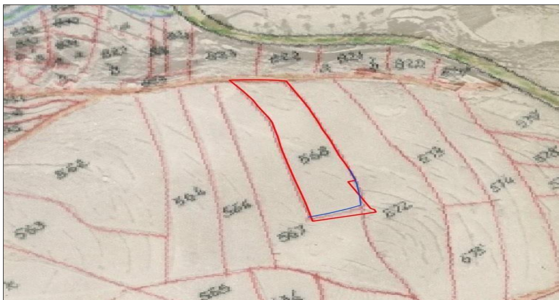
Plano de Catastro de Implantación de Rústica de los años 1956-1958 georreferenciado. En azul se marca el lindero físico reflejado en la ortofoto de 1961 anterior y en rojo, último levantamiento topográfico de los interesados.
